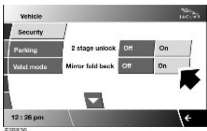
包含热熔断功能以保护后视镜折叠电机。 只有在后视镜处于展开位置时才会出现热熔断，并在5分钟后重置。
